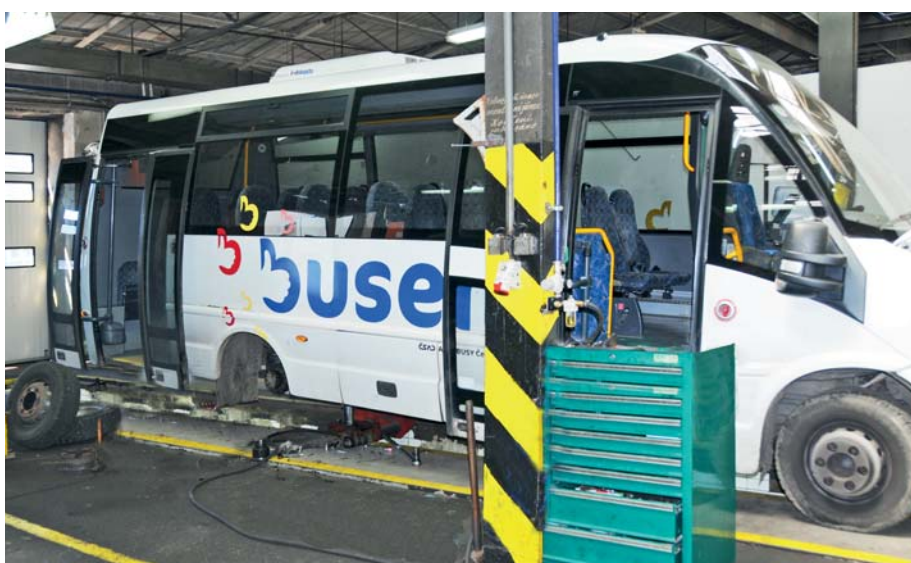
Opravovaný autobus Rošero. Šlo o celkovou opravu brzdové soustavy a výměnu listového pera.
