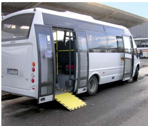
Dalším vozidlem, zkoušeným v provozních podmínkách, se stal minibus Rošero, postavený na podvozku Iveco s výklopnou plošinou pro invalidy a velmi nízkou průměrnou spotřebou 15 litrů na sto kilometrů.
