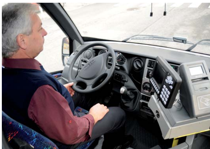
Pracoviště řidiče s odbavovacím systémem EMTEST MIJOLA 126 i
